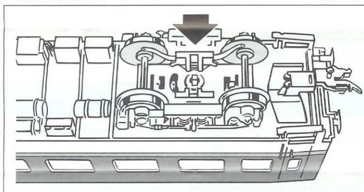
Mit den Fingernägeln in Höhe der Drehgestelle zwischen Wagenkasten und Wagenboden fassen und den Wagenkasten aufspreizen. Der Wagenkasten löst sich vom Wagenboden und kann nach oben abgehoben werden.
