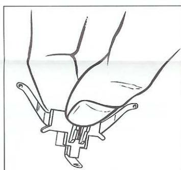
Die Radkontaktefeder in die Drehgestellöffnung einführen und durch Festdrücken einrasten lassen. Darauf achten, daß die beiden Radkontakte an den Radinnenseiten anliegen. Auf diese Weise zwei Radkontaktefedern montieren.
