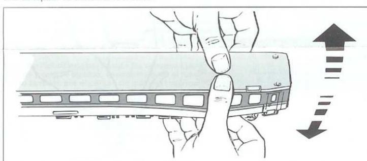
Glühlampe in den Lichtleiter einsetzen. Dazu Glaskörper der Glühlampe in die Aussparung unter die Haltenase I legen, Drahtenden an den beiden Klemmkontakten festklemmen. Freie Drahtenden um den Lichtleiter legen.
