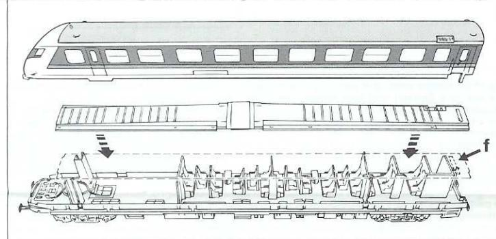
Den Lichtleiter auf die Inneneinrichtung legen. Der Steg f sichert den Lichtleiter auf der Inneneinrichtung gegen Verschieben in Längsrichtung.
